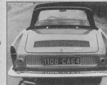
Arrivée du type R 1133 avec la Caravelle 1100. Sur la jupe AV, lettres CARAVELLE. Sur le capot AR (à droite), inscription 1100.
